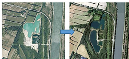
Exemple d'évolution de milieu sur une carrière de la commune de Donzère après exploitation entre 2006 (photo de gauche) et 2020 (photo de droite)
